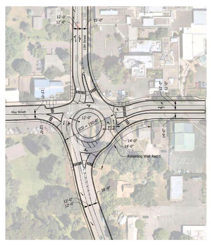
FIGURE 2. 13TH STREET/ MAY STREET ROUNDABOUT INTERSECTION CONFIGURATION
